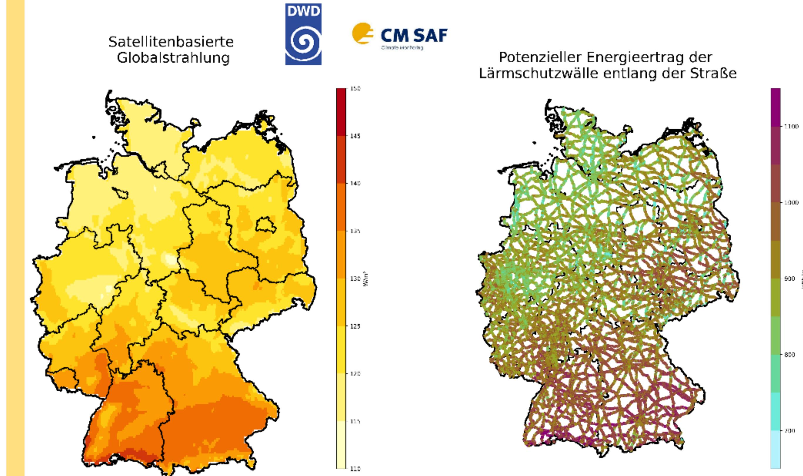
Solarstrahlung aus Satellitendaten (links) und in der Anwendung zur Bestimmung der möglichen Energiegewinnung, wenn alle Lärmschutzwälle entlang der Bundesstraßen mit Photovoltaikanlagen ausgestattet wären (rechts).
