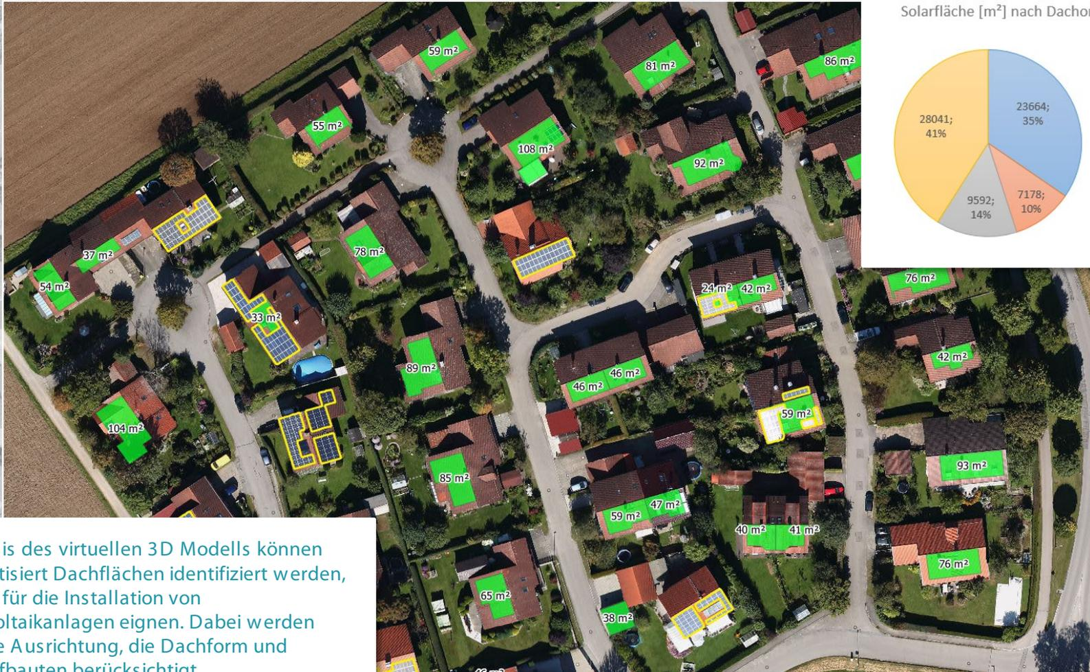
Auf Basis des virtuellen 3D Modells können automatisiert Dachflächen identifiziert werden, die sich für die Installation von Photovoltaikanlagen eignen. Dabei werden auch die Ausrichtung, die Dachform und Dachaufbauten berücksichtigt.
